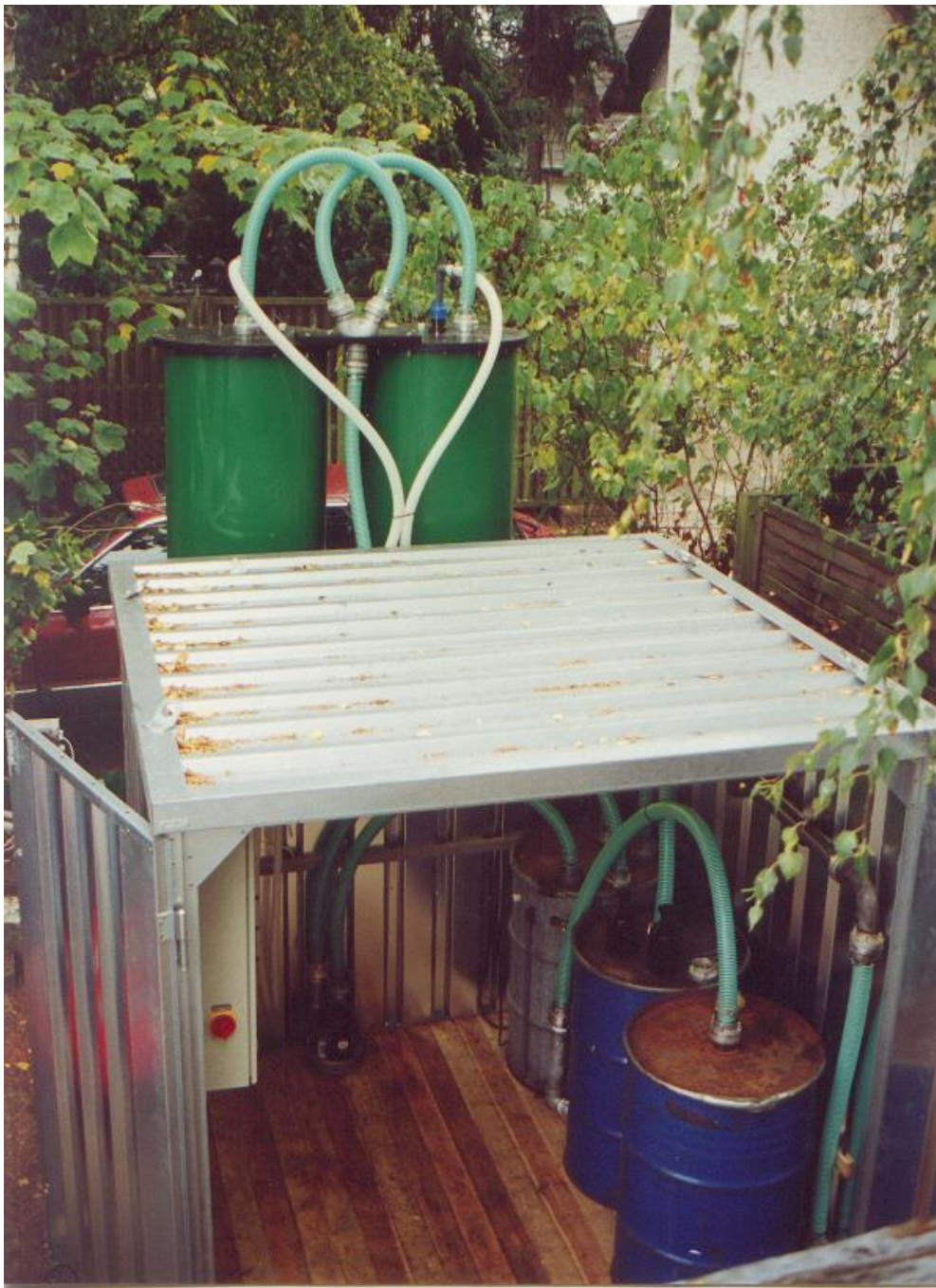
Abb. 4: Mehrstufige Wirbelkammerdesorptionsanlage mit Kleincontainer zur Aufnahme der Versorgungs- und Rohgasreinigungstechnik.
